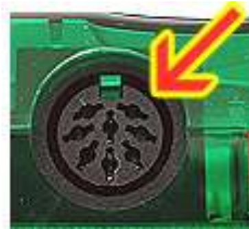
Fig. 6 8-pin DIN input
